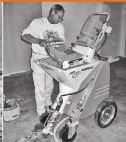
Umschaltbare Maschine PFT RITMO XL für den Stromanschluss 230 V und 400 V
