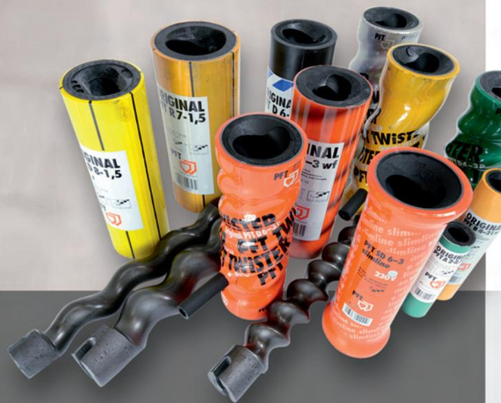
Das Herz einer Misch- und Förderpumpe ist die Pumpeneinheit, auch Rotor/Stator genannt. Hier wird der nötige Druck aufgebaut, um das Material an den Verarbeitungsort zu fördern. Je nach Baugröße können unterschiedliche Förderleistungen erbracht werden. Die letzte Ziffer der Pumpenbenennung bezeichnet dabei die Anzahl der Druckstufen, pro Stufe kann ein Druck von 10 bar aufgebaut werden. Werden diese Werte nicht mehr erreicht, ist die Einheit verschlissen und sollte ausgetauscht werden.
