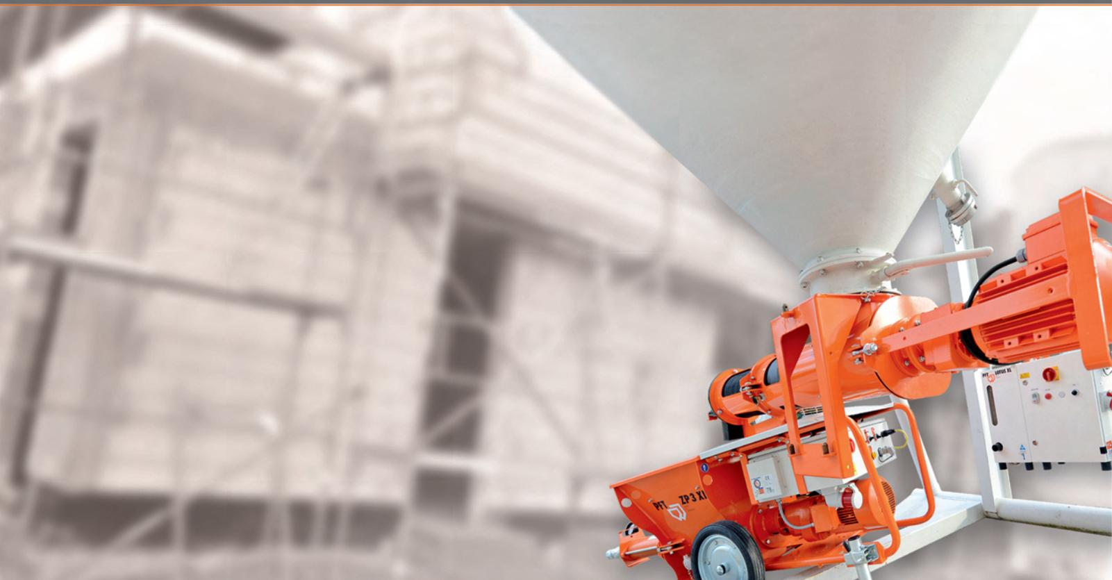
Die horizontalen Durchlaufmischer, auch bekannt als Mörtelmischer, mischen kontinuierlich und vollautomatisch alle Werk trockenmörtel auf Zementbasis zu einem verarbeitungsfähigen Material. So können Mauermörtel, Fugenmörtel, Ausgleichsmassen, Klebe- und Armiermörtel etc. entweder direkt verarbeitet, oder in Kombination mit einer Förderpumpe komfortabel
